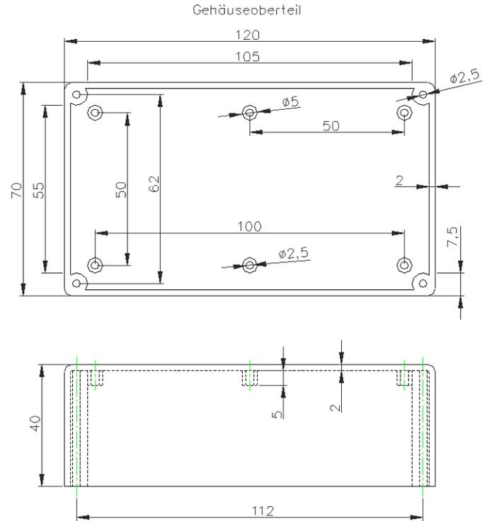
Gehäuseunterteil und Oberteil schwarz mit Befestigungsflächen und innenliegenden Befestigungsmöglichkeiten für Platinen im Gehäuseoberteil sowie im Gehäuseunterteil. Befestigung und Ansicht der Befestigungsflächen auf Blatt 2.
